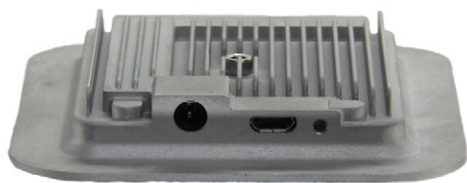
Figura A-4: Izda. - Alimentación, Centro - Micro USB, Dcha. - LED
